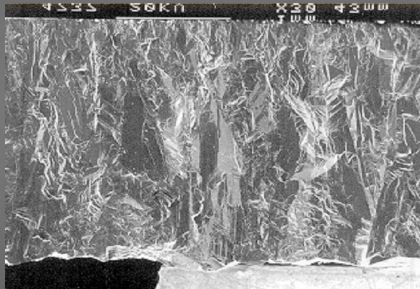
Микрофотография СЭМ отдельного алмазного слоя ГФХО алмаза толщиной 2,3 мм
