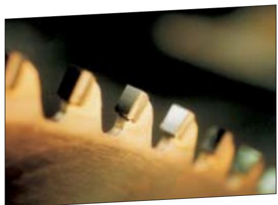
Монокристаллические алмазные зубья пилы, применяемой при разрезании ламинатных досок для полов.
