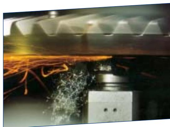
Токарная обработка поверхности закаленного конического зубчатого колеса осевого привода с использованием ПКНБ.
