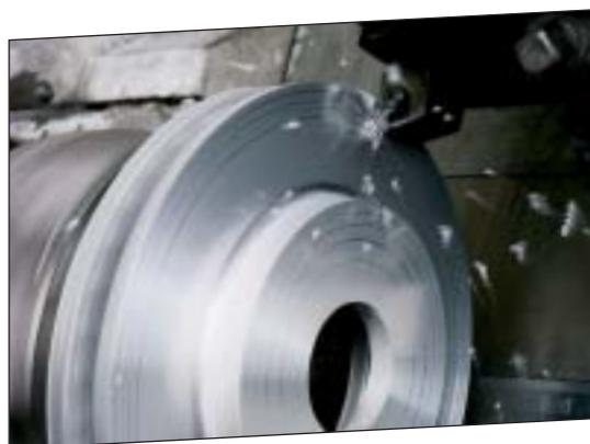
*Механическая обработка тормозного диска из упрочнённого металлом композитного материала резцом из ПКА Syndite.*
