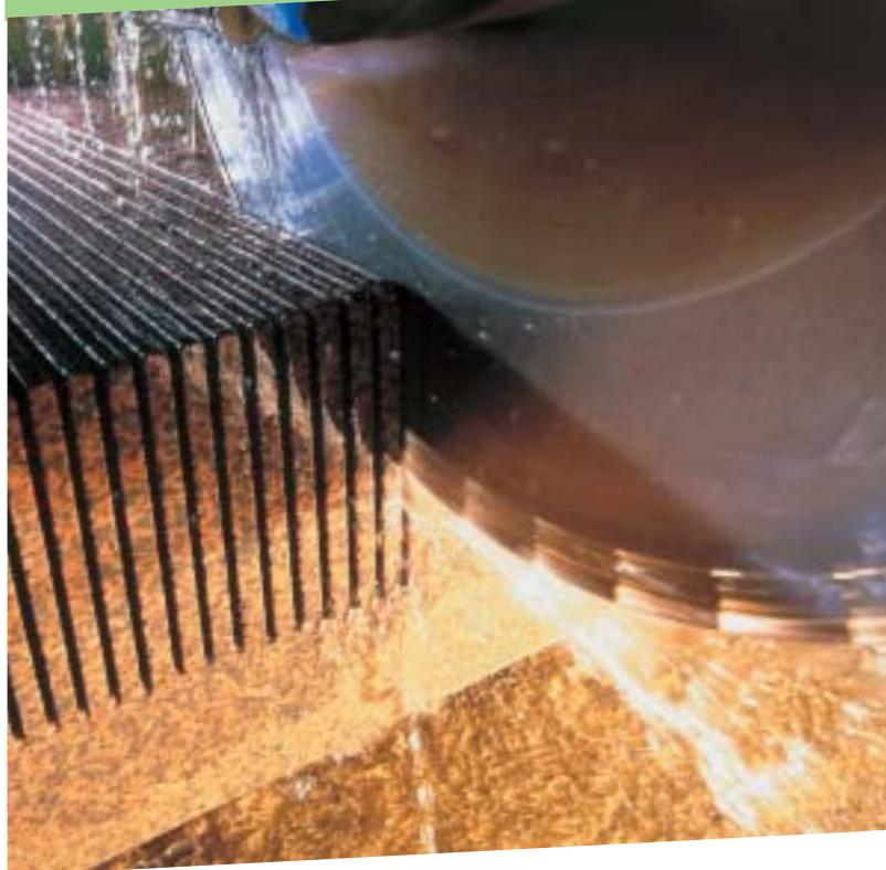
Рис 1. Наиболее крупными областями применения алмазных порошков являются резание, сверление и обработка поверхности натурального камня.
