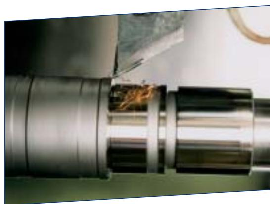
Токарная обработка закаленного цилиндра плунжера топливного насоса с использованием Ambarite DBN45.
