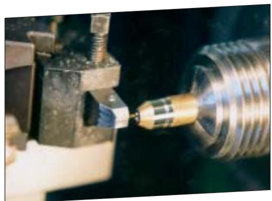
Нарезка внутренней резьбы в детали, используемой в стоматологии, при помощи алмазного инструмента на основе Monodite.
