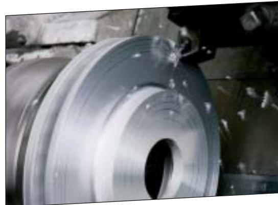
Механическая обработка тормозного диска из упрочненного металлом композитного материала резцом из ПКА Syndite.
